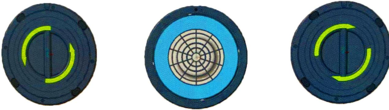
1. Drehen Sie die untere Abdeckung gegen den Uhrzeigersinn.
