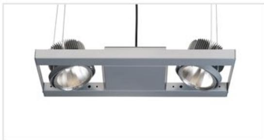
Der CARDANO®-S2 ist ein klassischer 2-lampiger PENDELSTRAHLER mit der beliebten CARDANO®-Technik im klassischen Design für Einsatz in Hallen, Foyers und Verkaufsräumen mit hohen Decken. Mit seiner hochoptimierten Lichttechnik und der kardanisch gelagerten Lichteinheiten mit 30° Schwenkbarkeit ist er ein ideales Instrument sowohl zur Akzentbeleuchtung als auch zur Grundbeleuchtung.
