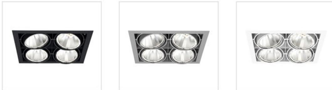
Der CARDANO®-E4 ist ein 4-lampiger Einbaustrahler mit der bewährten CARDANO®-Technik. Er ist konzipiert für den Einbau in abgehängte Decken. Mit seiner hochoptimierten LED-COB Lichttechnik und den kardanisch gelagerten Leuchteinheiten mit 30° Schwenkbarkeit ist er ein ideales Instrument sowohl zur Akzentbeleuchtung als auch zur Grundbeleuchtung.
