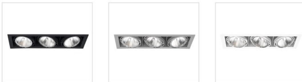
Der CARDANO®-E3 ist ein 3-lampiger Einbaustrahler mit der bewährten CARDANO®-Technik. Er ist konzipiert für den Einbau in abgehängte Decken. Mit seiner hochoptimierten LED-COB Lichttechnik und den kardanischn gelagerten Lichteinheiten mit 30° Schwenkbarkeit ist er ein ideales Instrument sowohl zur Akzentbeleuchtung als auch zur Grundbeleuchtung.
