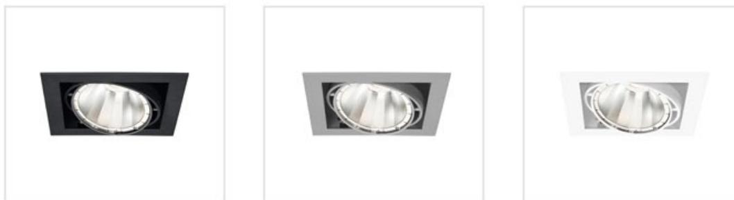
Der CARDANO®-E1 ist ein quadratischer Einbaustrahler mit der bewährten CARDANO®-Technik. Er ist konzipiert für den Einbau in abgehängte Decken. Mit seiner hochoptimierten LED-COB Lichttechnik und der kardanisch gelagerten Lichteinheit mit 30° Schwenkbarkeit ist er ein ideales Instrument sowohl zur Akzentbeleuchtung als auch zur Grundbeleuchtung.
