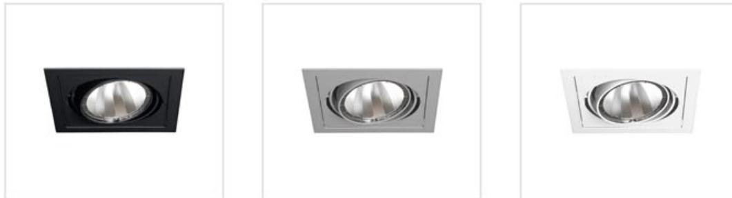
Die CARDANO®-E1 MODULAR ist eine Einbauleuchte, die aus Einbaurahmen und modularer Lichteinheit in bewährter CARDANO®-Technik besteht. Die kardanisch gelagerte Lichteinheit ist 30° schwenkbar und als Modul in wenigen Sekunden werkzeuglos austauschbar. Durch die hocheffiziente LED-COB Lichttechnik und die modulare Bauweise ist die CARDANO®-E1 MODULAR ausgelegt für höchste Ansprüche an eine variable Warenpräsentation.
